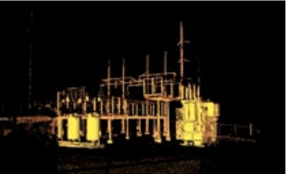
图 8 电力设备激光点云
